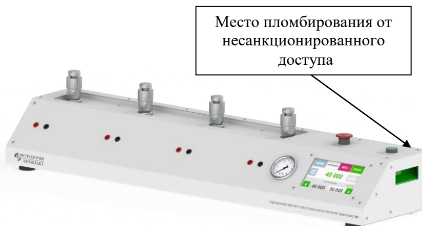
б) Общий вид интерфейсного модуля с указанием мест пломбирования от несанкционированного доступа.
