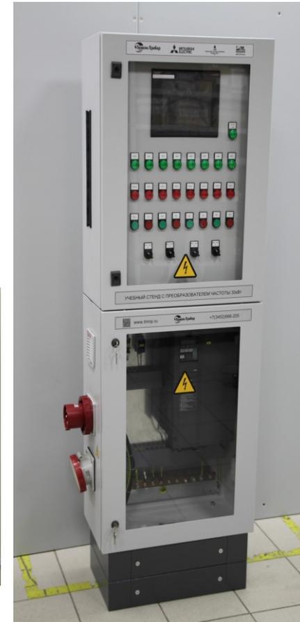
**Состав стенда:** контроллеры с модулями в/в, панели визуализации, прикладное программное обеспечение, специализированное промышленное оборудование
