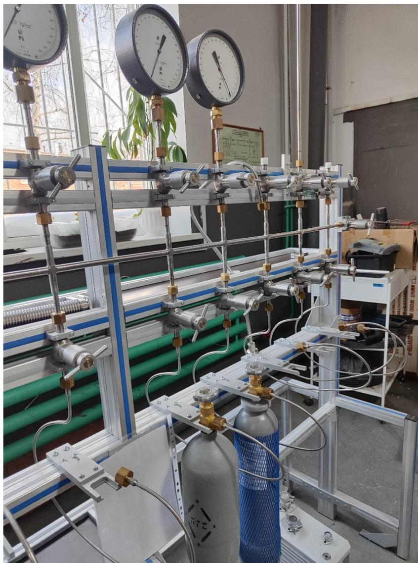
Производственная лаборатория ФБУ «Тюменский ЦСМ» занимается изготовлением стандартных образцов состава газовых смесей – поверочных газовых смесей (ГСО-ПГС). На данный момент разработан один широкоформатный тип стандартных образцов (ГСО-11113-2018) на основе метана, пропана и окиси углерода, который используются для градуировки, калибровки и поверки датчиков газоанализаторов, детекторов газовых хроматографов и др. СИ, контроля метрологических характеристик при
