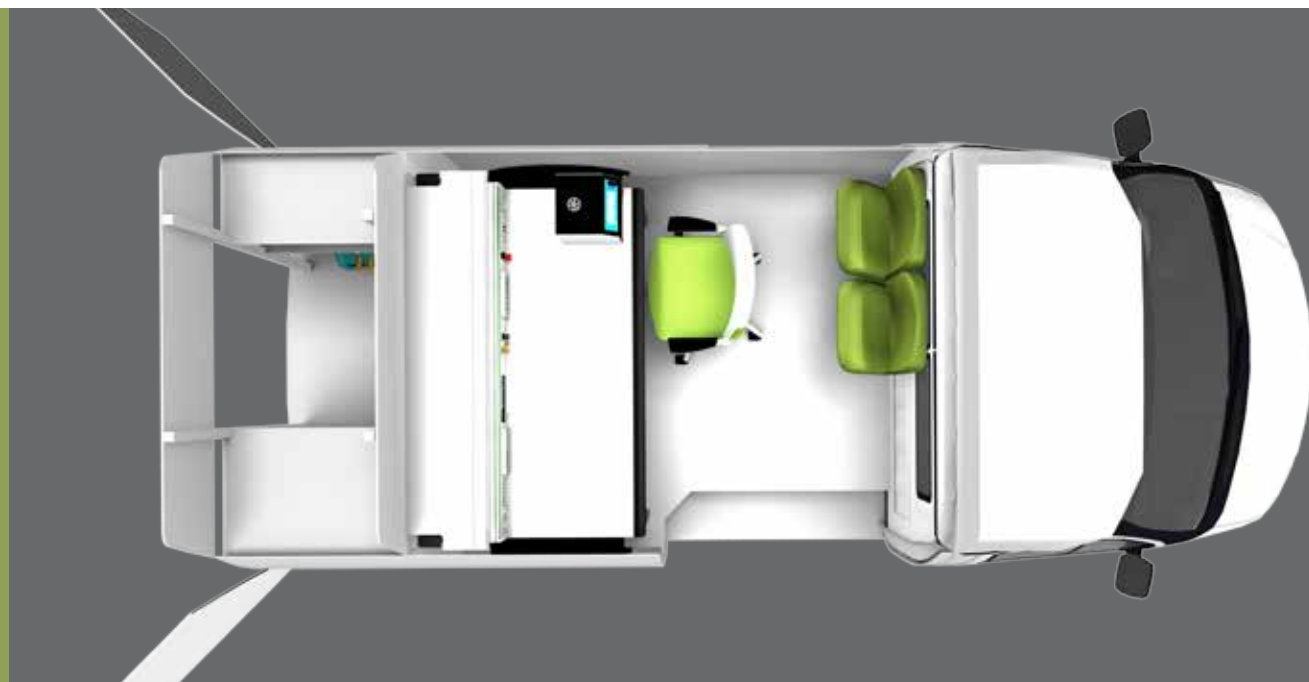
Автомобиль разделен на два отсека: лабораторный и технологический.
