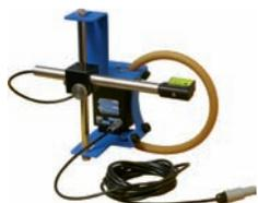
**AW0017XX** оптический датчик для отраженных световых сигналов с креплением к счетчику. Для проверки дисковых счетчиков и счетчиков с оптической импульсной индикацией.
