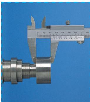
Измерение наружных размеров
