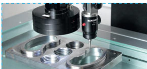
Для моделей NVM-3020D, NVM-4030D и NVM-5040D возможна установка контактного датчика Renishaw.
