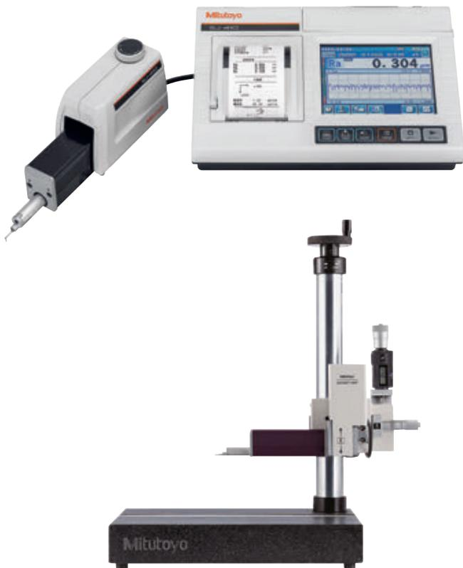
Устройство дополнительной подачи по оси Z
