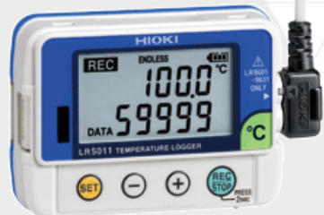
LR5011 Регистратор температуры Температура: -40^{\circ}\text{C} до 180^{\circ}\text{C}
