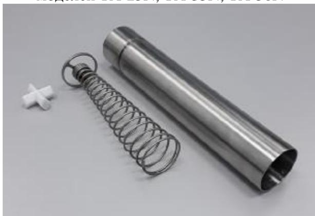
Рисунок 17 - Общий вид сменных жидкостных вставных блоков для калибраторов моделей ТА-25NL, ТА-45NL, ТА-60NL
