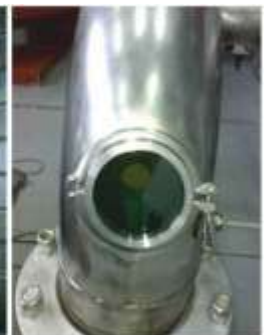
Рис. 32. Прозрачный участок трубопровода и системы очистки
