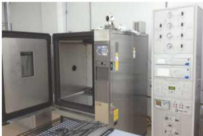
Рис. 11. Калибровочная станция давления и контроллеры высокого давления
