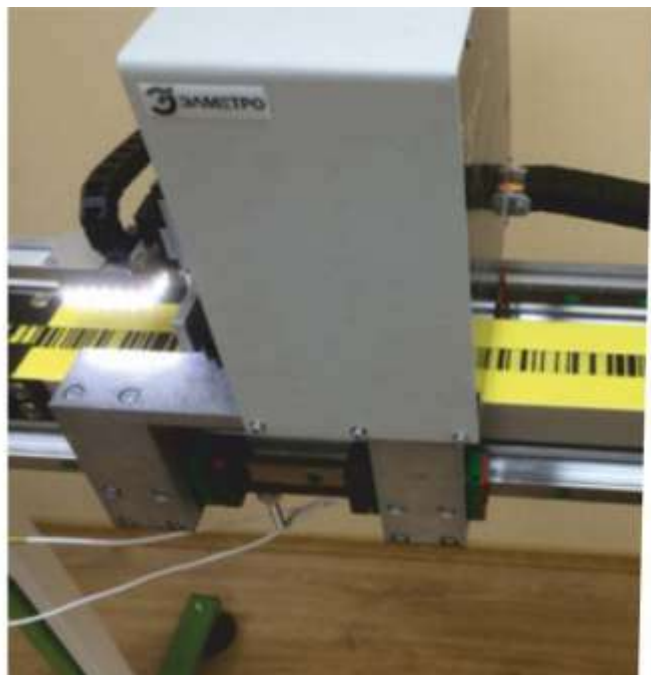
Рис. 23. Метрологическая установка для измерения длины ЭЛМЕТРО-ЛИЗА
