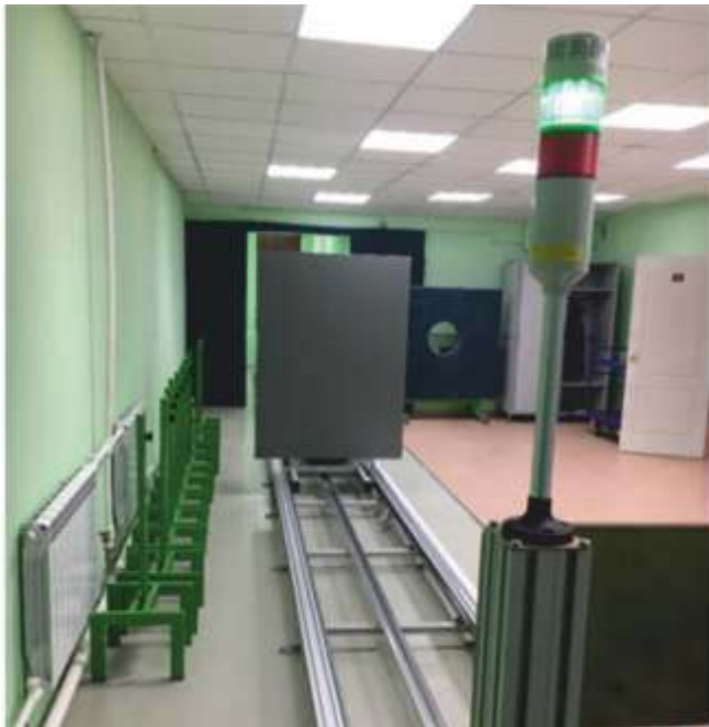
Рис. 19. Стенд поверки, калибровки и ремонта радарных, рефлекс-радарных, ультразвуковых, поплавковых и волноводных в т. ч. тросовых, уровнемеров. Стенд сдан и запущен в промышленную эксплуатацию в компаниях Западной Сибири, Республики Татарстан и регионального ЦСМ Поволжья
