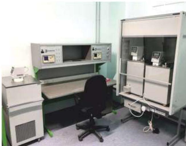
Рис. 15. Стенд поверки, калибровки и ремонта преобразователей температуры
