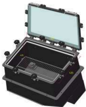
Рис. 10г. Большая камера для поверки большого числа барометров и метеостанций, содержит гермовводы с питанием от сети 220 В и низковольтные разъёмы для подключения вспомогательной периферии (калибраторы, цифровые интерфейсы ПК, преобразователи)
