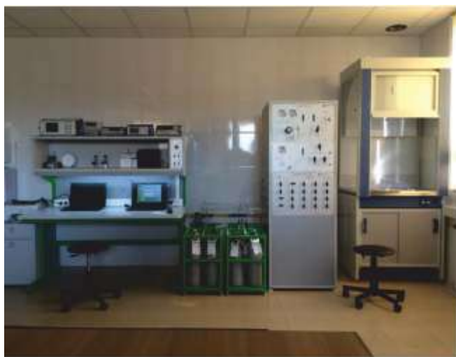
Рис. 16. Стенд поверки, калибровки и ремонта газоанализаторов в одном из ЦСМ
