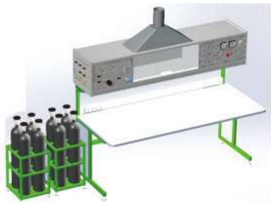
Рис. 18. Ручной стенд для поверки газоанализаторов. Рабочее место 3 в 1
