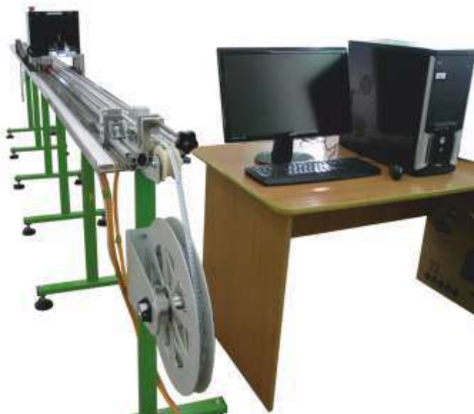
Рис. 22. Метрологическая установка для измерения длины ЭЛМЕТРО-ЛИЗА
