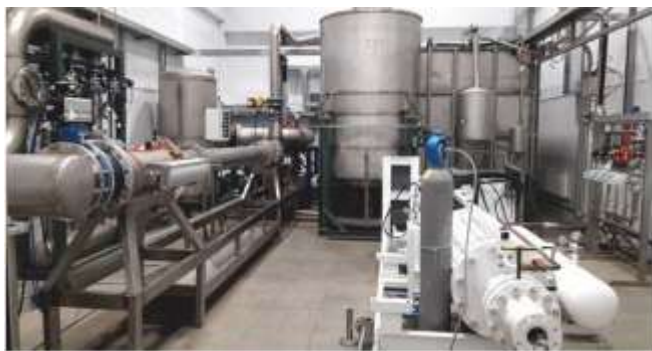
Рис. 24. Установка поверочная проливная с расходом 600 м 3 /час
